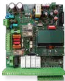
Platine seule STARTECO PLUS Sortie 2 moteurs 230 Vac Code : FTY 2STPL
