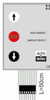
Clavier auto-manu pour STARTÉCO 3 Clavier adhésif avec 4 boutons sensitifs (limande L=50cm) (ouverture/fermeture/ stop/sélecteur auto- marche forcée) Code : FZI 04BPL
