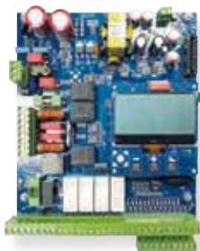
Platine seule START-ONE Sortie 2 moteurs 230 Vac Code : FTY 00ST1
